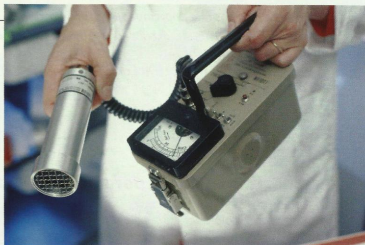
Doc. 1 Le compteur Geiger permet de détecter les sources radioactives grâce au rayonnement émis.
